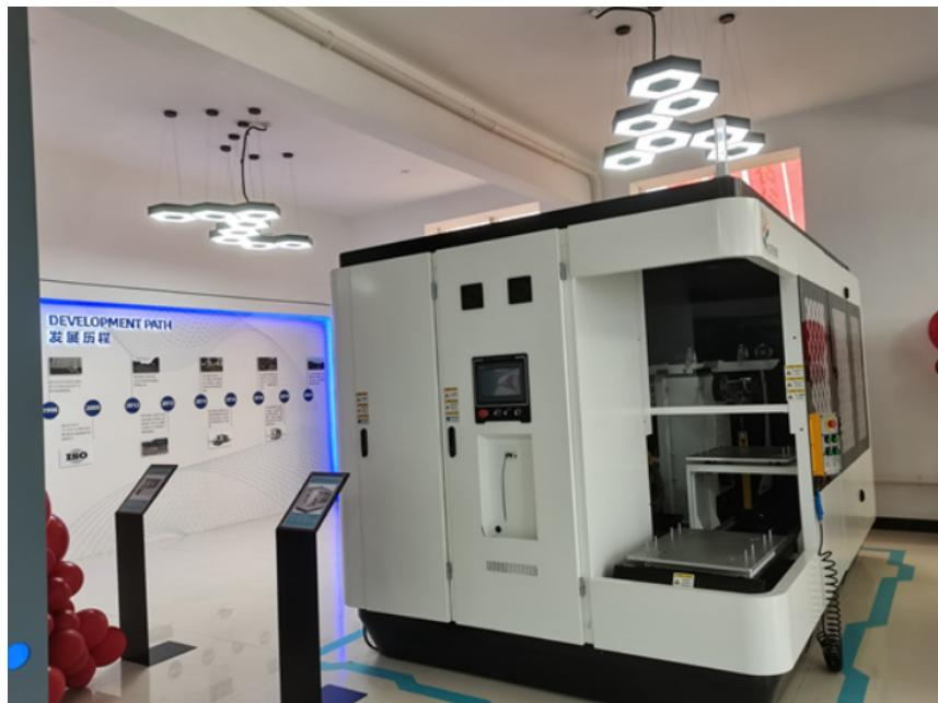
去毛刺机的生产规程是一个可重复的和均匀的工艺，不受任何磨损介质的影响。通过热能去毛刺机的操作，所有在预加工过程中产生的其他方法无法去除的毛刺和残留物都可以被完全清理干净。对单一、多个或是散料工件不只在加工节拍，而且在加工质量上都均匀一致。通过控制引的爆包围工件的混合气体所产生的短暂的热量，超过附着在工件上毛刺及污物的燃点，使其氧化或燃烧，这就是整个热能去毛刺机运作的生产规程。去毛刺机的生产工艺是一种非常规的但安全的去毛刺方式，用于完全去除松散的，固定形状的毛刺及工件表面的附着物。湖北压铸件去毛刺设备安排加工顺序时，应尽量将产生毛刺的工序安排在前，而把不产生毛刺的工序安排在后。
